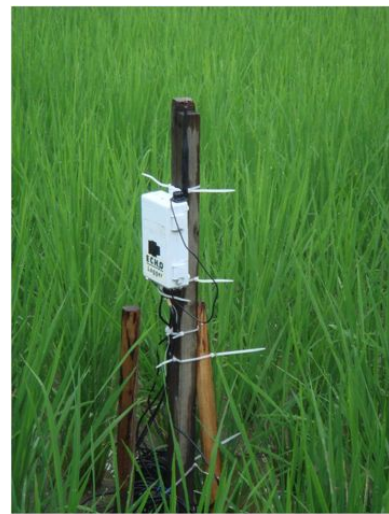
写真4 稲の生育状況と水田土壌水分の測定中
