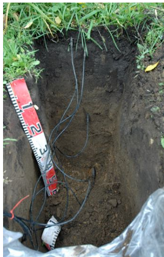
写真1 土壌水分センサー埋設状況
