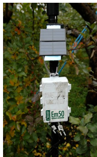
写真4 データロガー+通信部分
