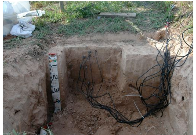
写真2 土壌水分量センサー埋設状況
