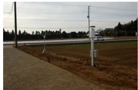
写真4 設置後の土埃観測装置 Vaisala 気象計 (左) とフィールドサーバ (右)
