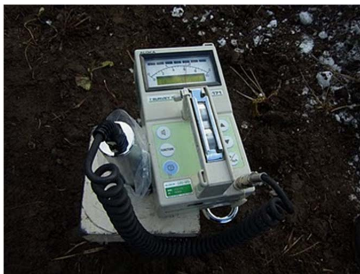
写真2 鉛コリメータ付ガンマ線計による地表面の放射線量測定
