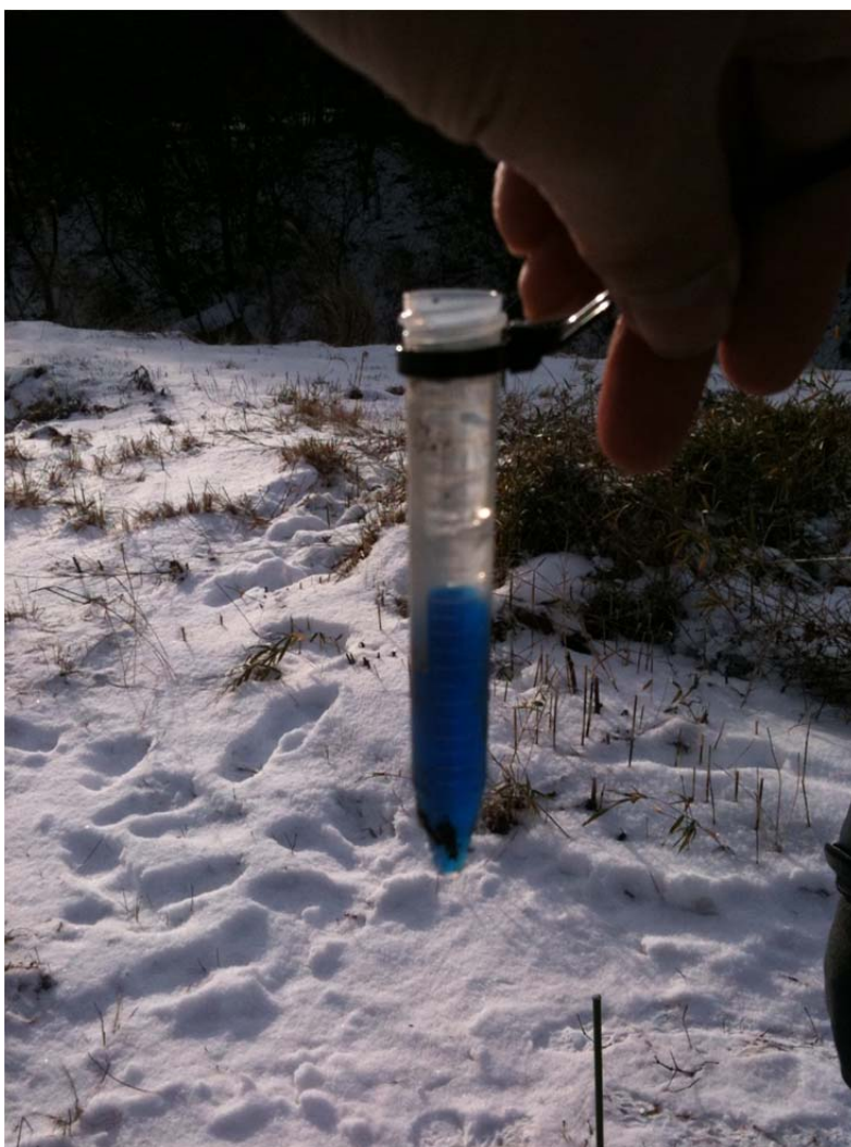
写真 4 簡易土壌凍結深度計による凍結深度の測定例
