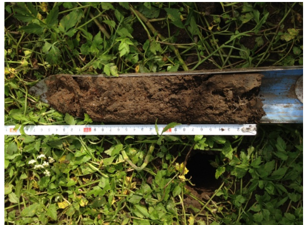
2012.8.26 排水溝の土壌採集。これを1cmごとに袋に詰め、放射性セシウム濃度を測定。
