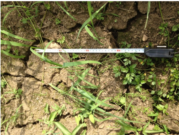
2012.8.26 泥水が排水溝表面に捕捉されたことを示す粘土特有の亀裂
