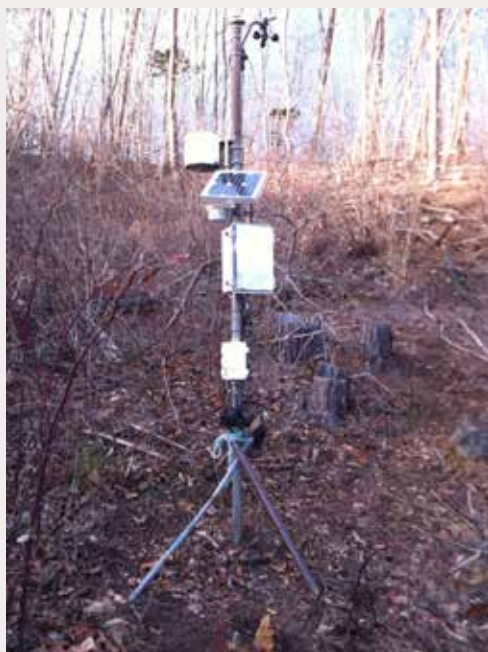
森林の空間線量を自動計測するためのシステム
