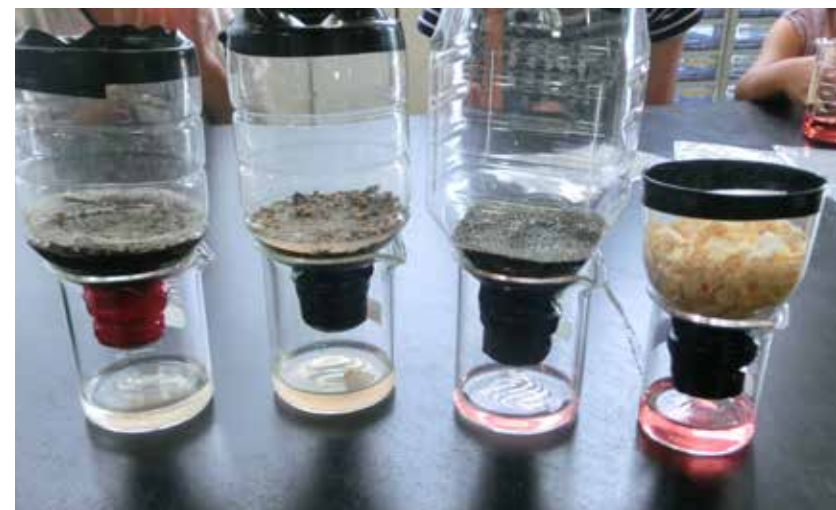
ペットボトルを使った吸着実験の様子（左から、畑の土、山の土、海の砂、おがくず）
