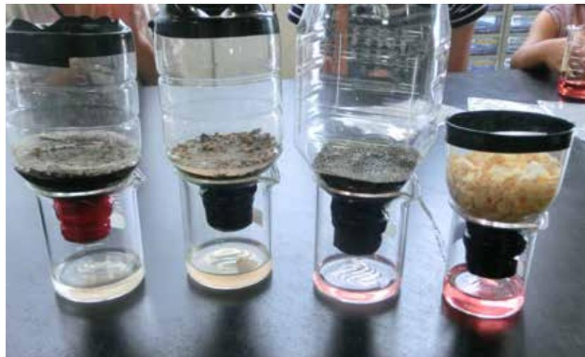
用塑料瓶进行吸附实验的样子(从左开始,田里的土、山上的土、海里的沙、锯木屑)
