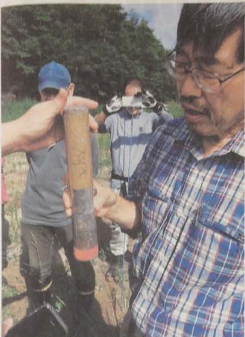
除染された田んぼで採られた土。写真のサンプルは、山砂の厚さが約15センチ(容器の上半分)＝8月30日、福島県飯館村須賀
