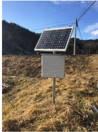
図 4 フィールドで WiFi を使えるようにするためのリピータシステム。 これによりフィールド内で WiFi 通信する範囲が広がる。
