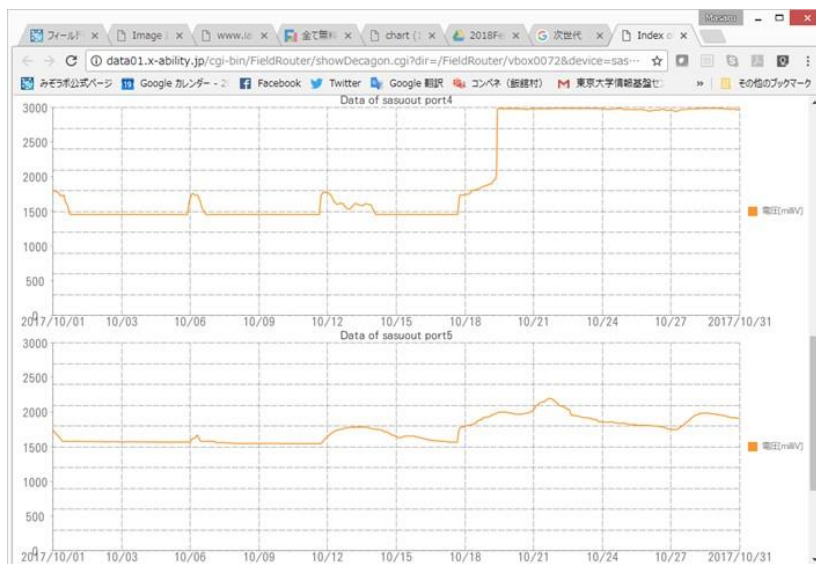
図 2 水田の水口に設置された水位計と濁度計によって測定された田面水の水位変化と農業用水の濁度の変化（1 時間ごとのデータがクラウドサーバに自動送信される）
