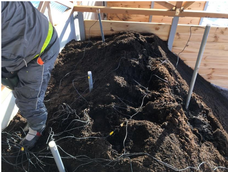
Fig.14 塩ビ管に固定したセンサーを縦方向に設置
