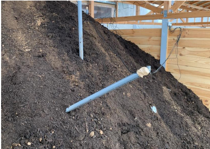
Fig.13 塩ビ管に固定したセンサーを横方向に突き刺した
