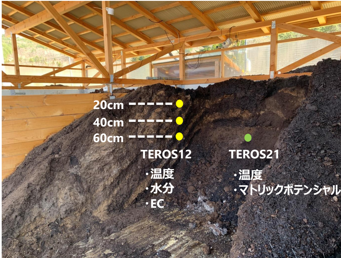
Fig.10 センサー設置深度
