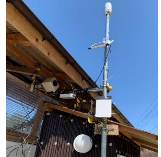
Fig.11 データロガー外観 METER社製 ZL6 (測定間隔: 15分)
