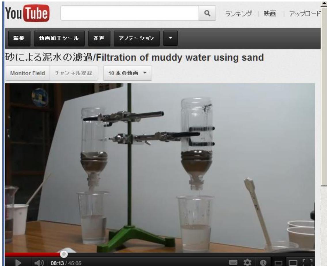
泥水は砂の層を通るだけで透明になって出てくる。放射性セシウムのほとんどは粘土粒子に強く吸着(固定)されているので、セシウムだけが水中に溶け出すことはない。
