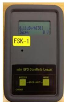
図 2-8 GPS ロガー付き放射線量計
