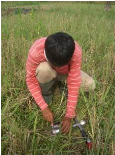
図 19. 採土器による土壌採取(左)、カップによる土壌採取(右)
