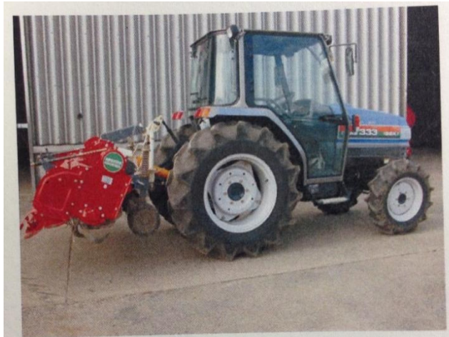
ロータリをトラクタに直結させた専用機
