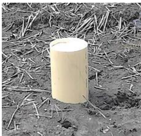
図 13. Vented chamber 側面図
