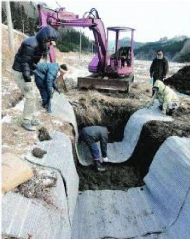
田んぼの凍った土をはぎ取って埋める溝口教授らの実験
