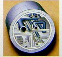
地下ガストンネル
