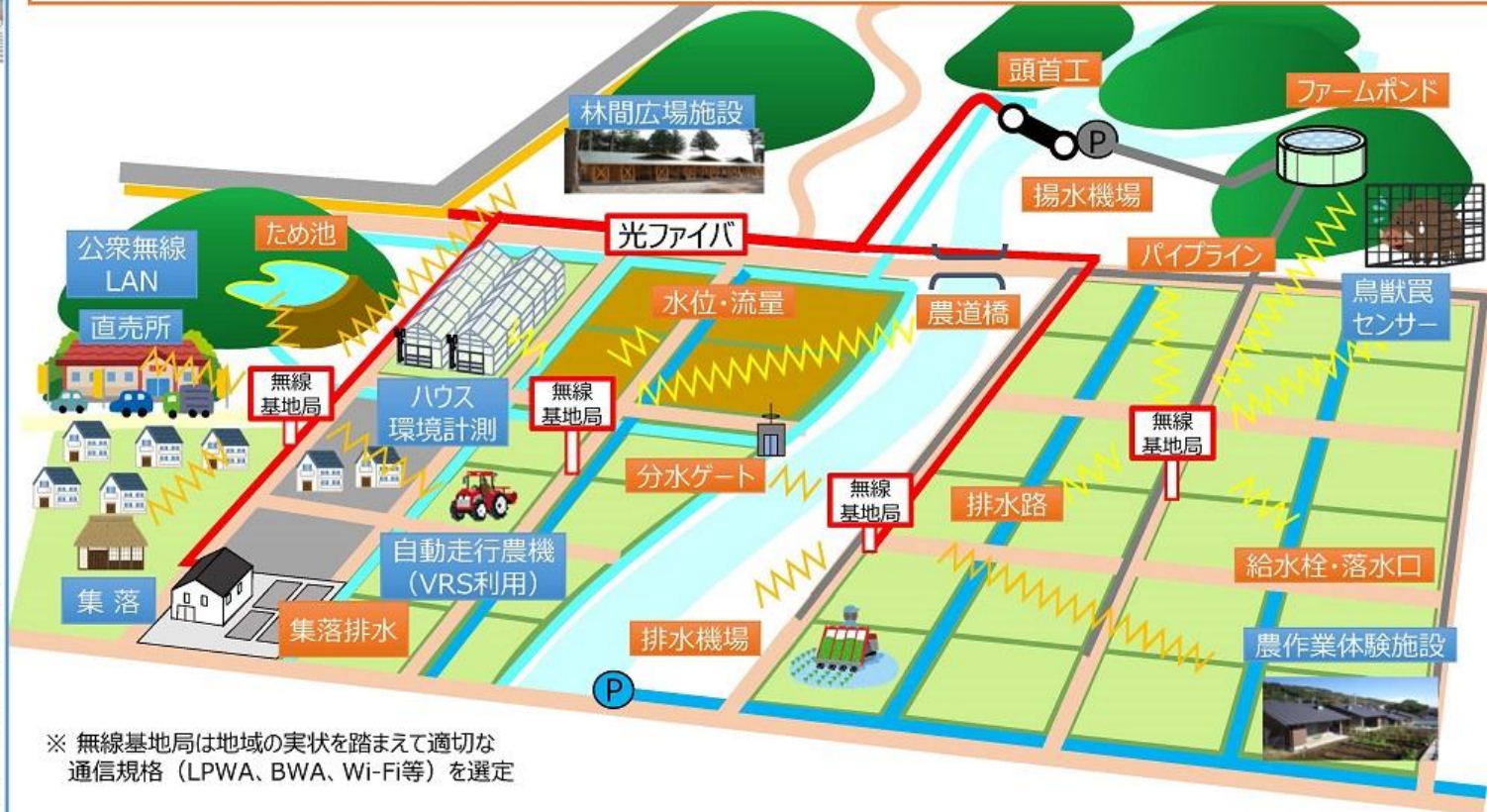
分水ゲートの 監視・制御
