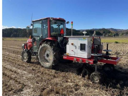
図1 本研究で使用したトラクタ搭載型の土壌分析システム。
