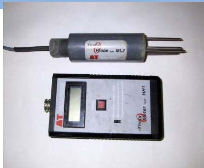
9Vの印可電圧、0-1Vの出力
