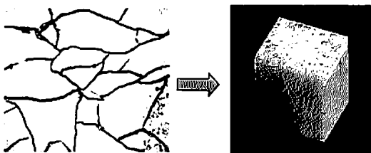
a) 試料断面氷結晶の2値化画像 b) 3次元再構築画像 図10 近赤外分光マイクロスライサによる凍結寒天 内氷結晶の計測例
