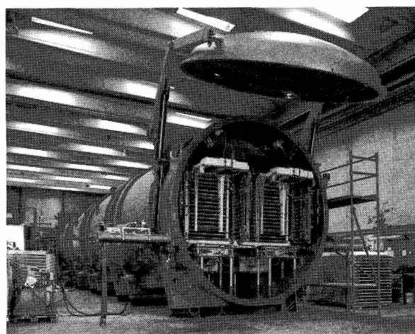
図 8 連続式凍結乾燥機チャンバー内のラック式乾燥棚
