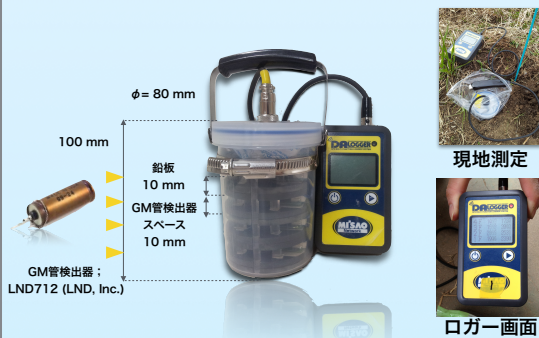
Fig. 1 土壌放射能鉛直分布測定器「土壤くん」
