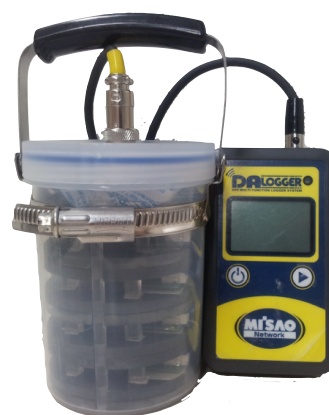
Fig. 1 土壌放射能鉛直分布測定器「土壌くん」
