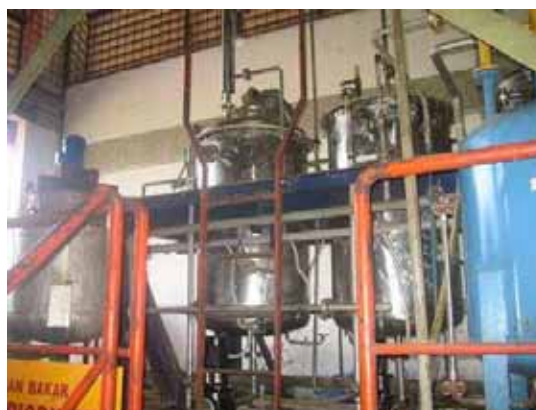
写真10 BDFのバッチ式プラント
