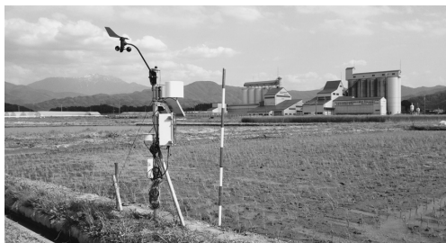
写真-1 水田に設置された気象計とFMS(中央の箱がFR)
