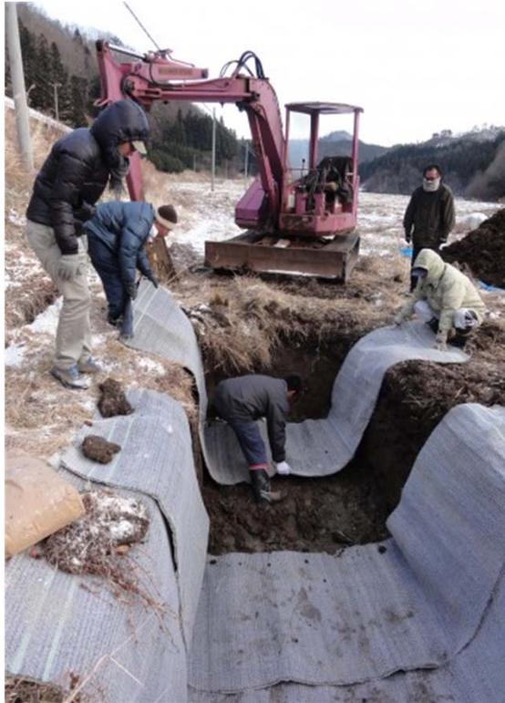
汚染凍土の埋設試験(2012.1.14)
