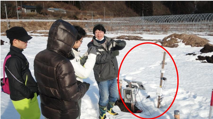
水田でのモニタリングの様子を見学する一同。丸部分がモニタリング機器。この装置で水田の放射線量や気温、水温などを計測していた。これらの測定した情報はネット上で見ることができる。
