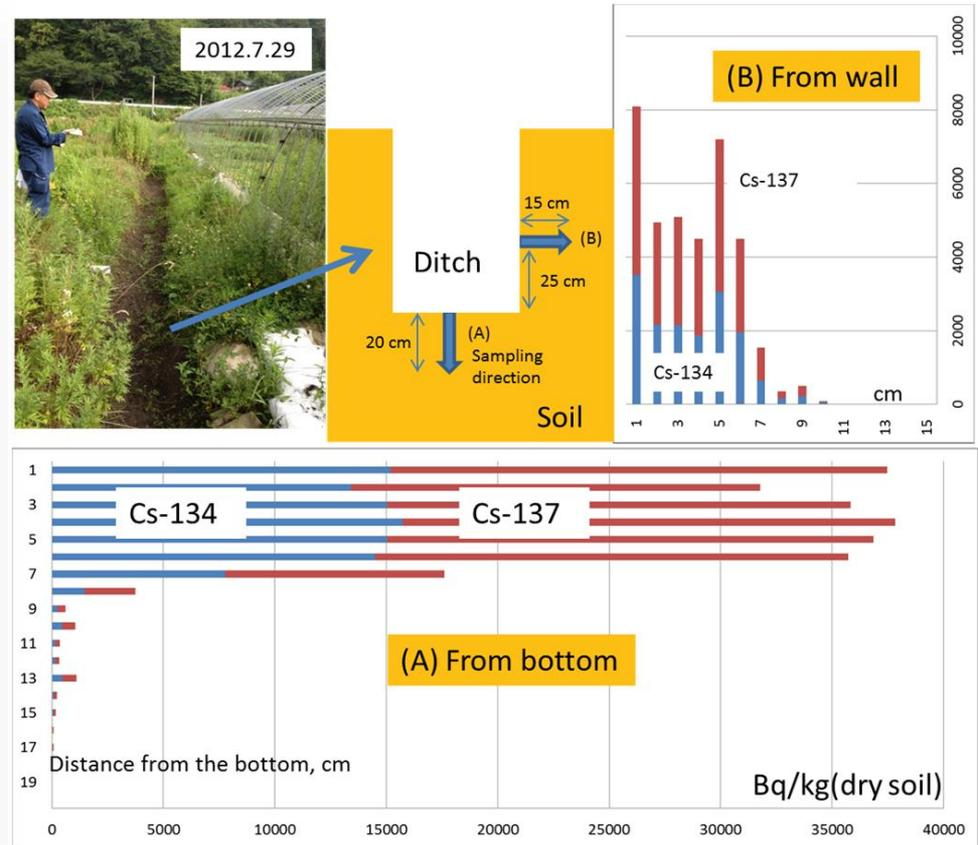
洗い流した泥水を溝に蓄積しておき、干上がった後に溝の底と側面の土壌をサンプリングして深度別に放射能測定した結果。
